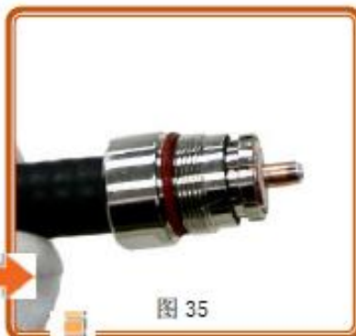
图 35 内外套平， 接好后套
