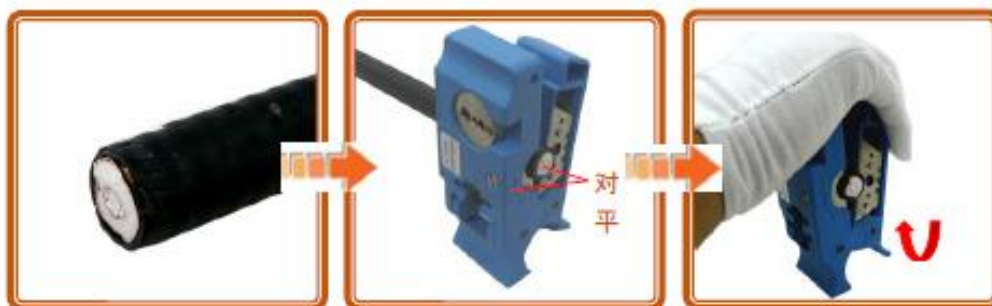
图20 切割馈线，切割面应正切于波顶处
